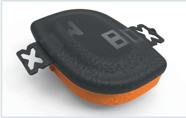
Bild 3. Seitenansicht der MEXbox mit geöffnetem Verschluss. Die Oberflächenstruktur verdankt sich einer Werkzeuggravur des Projektpartners Reichle. Daneben die Auswerferseite des 1,45 Tonnen schweren Familienwerkzeug für Behälter und Deckel (© Reichle Technologiezentrum/Hochschule Reutlingen)
