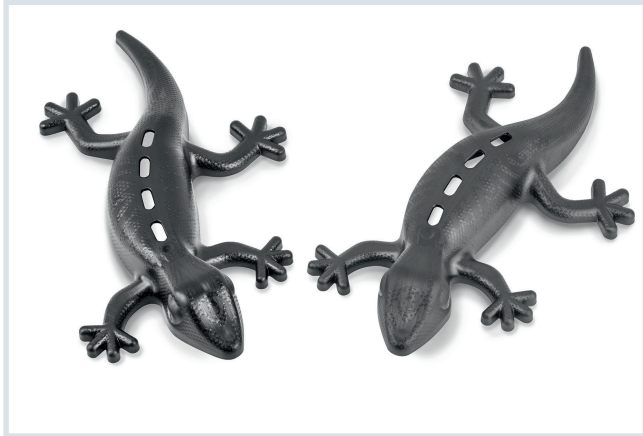
Bild 2. Der „Gekko“ entfaltet nur mit variothermer konturnaher Temperierung (rechts, konventionell gefertigt links) die gewünschte Oberflächenstruktur. Diese wird mit einem Laser in die Werkzeugoberfläche eingebracht (© Contura MTC/Reichle Technologiezentrum)
