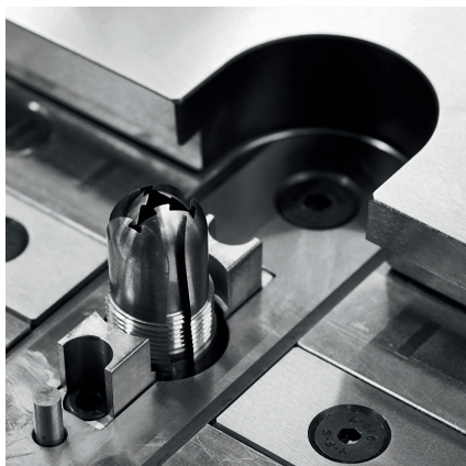
Bild 5. Einfallkerne lösen Entformungsschwierigkeiten bei Hinterschneidungen oder Gewinden
